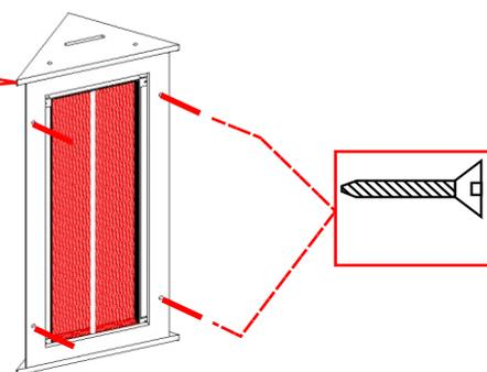
Nota: conecte el cable del calentador frontal; distancia del calentador frontal del panel del piso aproximadamente 360 mm.
