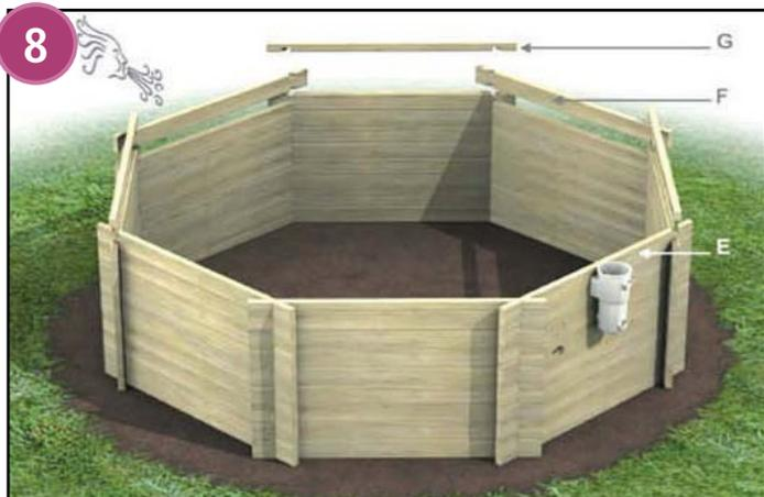
Encaje la pared mecanizada complementaria para skimmer (tipo E) por encima de la pared de tipo D y seguir así por toda la periferie de la piscina, encajando 3 paredes (tipo F) y 4 media-paredes (tipo G) como en la ilustración
