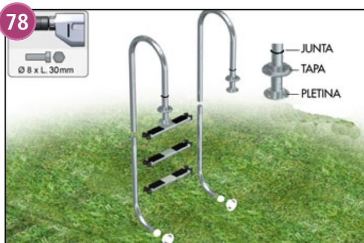
Ensamble la escalera de acero inoxidable - véase el manual entregado en el embalaje. Encaje las platinas y los elementos de caucho. A la hora del ensamblaje de las partes superiores, no olvide colocar sobre cada uno de los tubos las juntas de caucho destinadas al mantenimiento de las tapas embellecedoras
