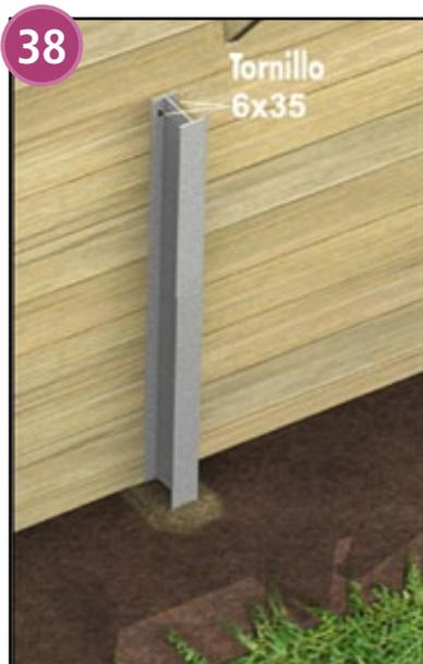
Después de haber comprobado el aplomo de los soportes, bloquear las cabezas de las cunas con los 4 tornillos (bolsa C).
