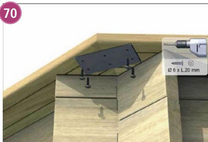
Le queda por fijar a los 8 ángulos de coronación, las piezas de unión (bolsita 27511671) - ver imagen - comprobando que la pieza haga tope de retención contra el ángulo formado por las láminas sobresalientes.
