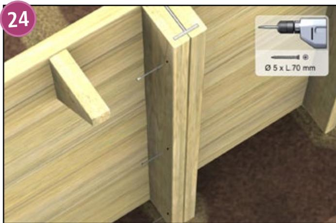
Cerrar por el exterior, los soportes de cunas metálicas (éstos son preperforados) sobre las paredes mediante tornillos 6x40mm (bolsa C) comprobando de nuevo su equilibrio. Coloque por cada lado de las cunas dos perfiles de revestimiento (Q) luego júntelos como en la ilustración con la ayuda de 3 tornillos 5x70 (bolsa C).
