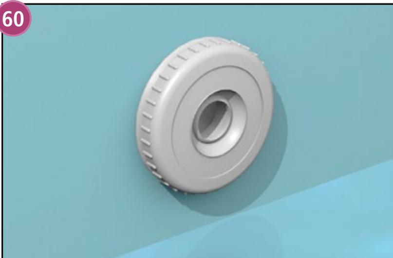
Atornille el conjunto rótula orientable sobre el cuerpo del retorno. La rótula ha de ser orientada hacia la izquierda para favorecer un movimiento de agua necesario para el buen funcionamiento de la filtración.
