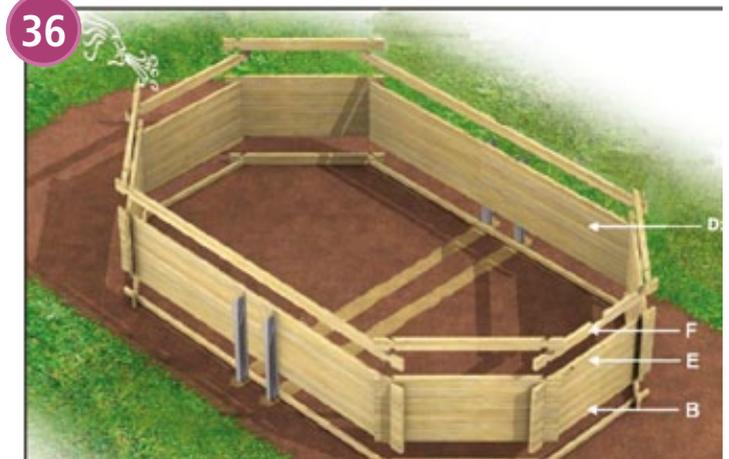
**Ilustración 46 :** Encaje el conjunto de las paredes restantes (B), para los pequeños lados, con las paredes (D) grandes lados vigilando el posicionamiento de la pared perforada (E) destinada al retorno, de la pared fabricada (F) (para el posicionamiento de estas láminas véase despice al final del manual). La pared de retorno (E) debe situarse encima de 4 paredes (B) + 1 pared (A). La pared (F) se situa en el mismo lado en el último rango de esta etapa de montaje.
