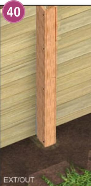
Posicione el revestimiento sobre la cuna. Procure que la altura de las tablas sea bien a ras de la altura de la pared. Atornille por el interior, como indicado, efectuando un preagujero. Después de atornillar compruebe la ausencia de astillas que pueden dañar el liner.
