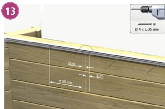
Fijar el carril con un tornillo de 2 cm de cada extremidad. Y complementar la fijación por un tornillo cada 20 cm aproximadamente.
