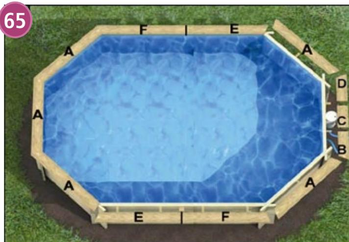
Después de haber observado sobre el dibujo la repartición de las diferentes tablas que constituyen la coronación, dispóngalas sobre las consolas. Controlar el posicionamiento de los elementos en toda la periferie del vaso. Si necesario ajuste y conserve este posicionamiento hasta el atornillamiento.
