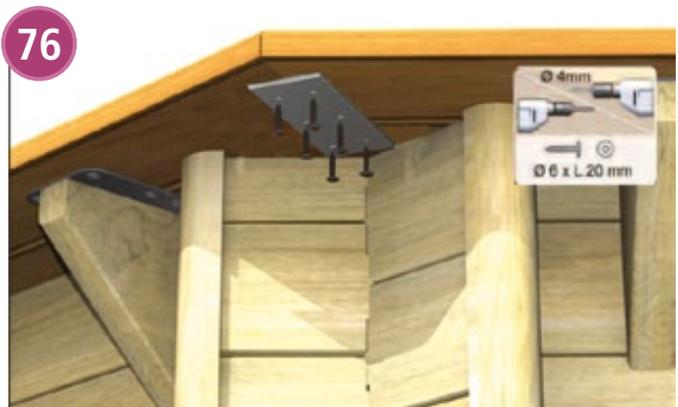
Nos queda fijar las 8 piezas de unión de ángulo (kit mantenimiento incluido en el bulto coronación) bajo la coronación con la ayuda de tornillo. Coloque la placa apuntalada en el ángulo formado por los bordes de las láminas. Fije los picaportes (bolsa N) como en la imagen.
