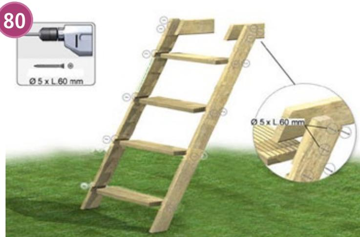
Vd. encontrará los lados de la escala así como los peldaños en el kit madera de su piscina. Ensamble la escalera utilizando los tornillos de acero inoxidable (bolsa K). Para un ensamblaje más eficaz y más limpio, es aconsejado de preagujear a 4 mm de diámetro antes de atornillamiento y fresar los preagujeros con el fin de evitar hender la madera y provocar astillas. Vigile el sentido de montaje del conjunto.
